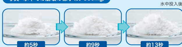
写真 水中での崩壊の様子(例:330mg)
